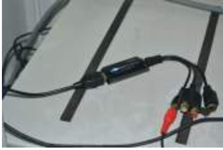
Video Capture Card - Satu contoh Video Capture Card yang digunakan disambung kepada komputer
